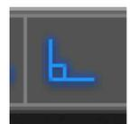
Ubicado en la Barra de estado, este comando nos permite restringir el movimiento de las líneas en los ejes X/Y (ortogonal).
